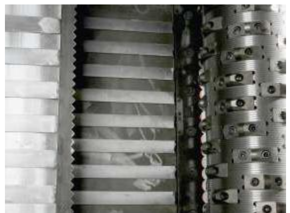
Rotor – 354 Ø mm avec 3 rangées de couteaux
