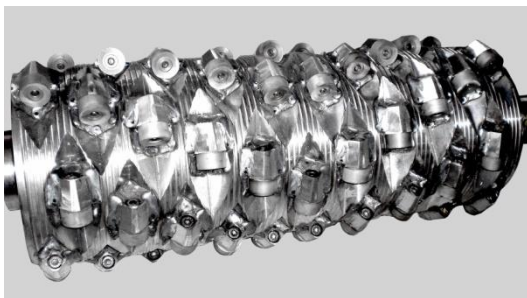
Rotor Ø 252 mm avec trois rangées de couteaux.
