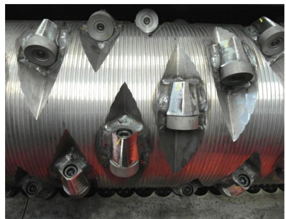
Rotor Ø 354 mm avec 2 rangées de couteaux
