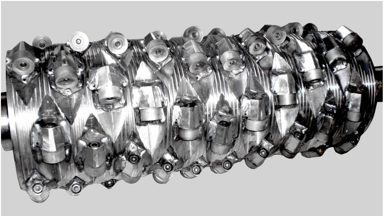
Rotor \varnothing 252 mm avec 63 couteaux circulaires V 8 (3 rangées de couteaux)
