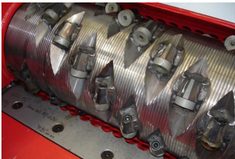
Rotor Ø 354 mm avec deux rangées de couteaux
