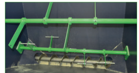
Outils de mélange intégrés pour éviter la formation de voûte lorsque la matière est très légère
