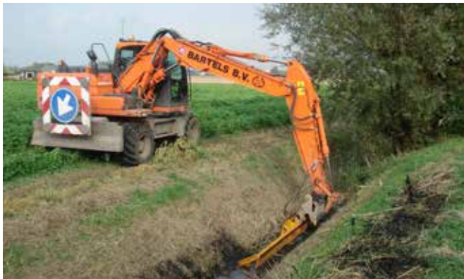
Un panier faucardeur Herder peut être monté directement sur l'excavateur.
